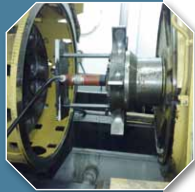
Koppeling wordt van de asgenerator afgeperst
