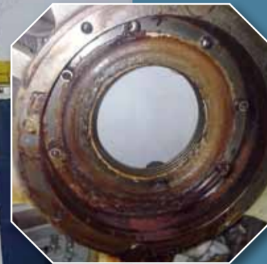
Na meting bleek lagerschild uitgelopen te zijn
