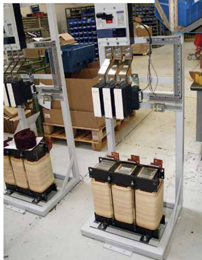
< Frame van een besturing die nog in een kast geplaatst dient te worden.
